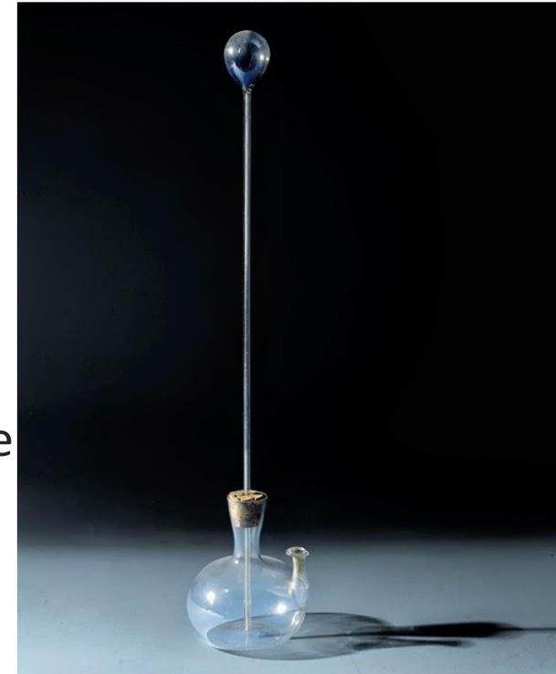
Galileo scoprì anche che oggetti (sfere di vetro riempite di **alcol** acquoso ) di densità leggermente diverse si sollevavano e si abbassavano, che è oggi il principio del termometro di Galileo.
